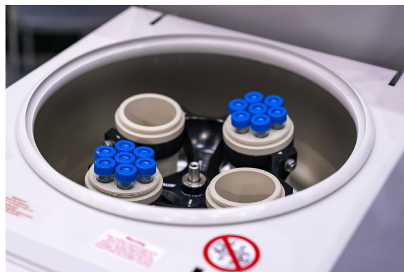
Zentrifugen nutzen die Zentrifugalkraft, um Gemische zu trennen
