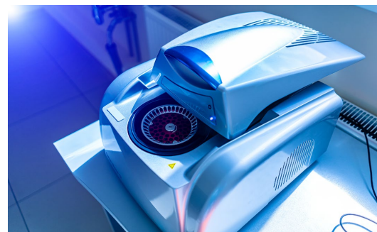
Moderne Thermocycler nutzen thermoelektrische Technologie für die genaue Temperaturkontrolle und steile Temperaturrampen.
