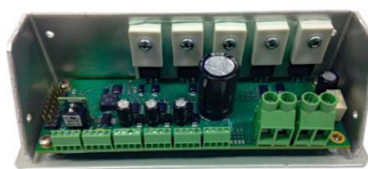
Der programmierbare Temperaturregler SR-54 stellt in Kombination mit einer thermoelektrischen Kühlerbaugruppe eine komplette Wärmemanagementlösung dar.
